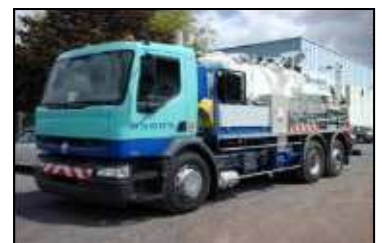
traitement du liquide par "USSU" et retour à la fosse
