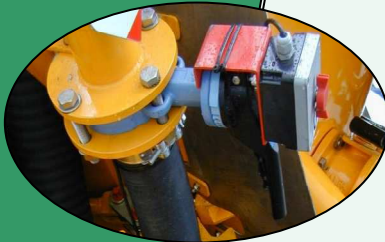
Vakuumbrecher mit verzögerter Oeffnung
