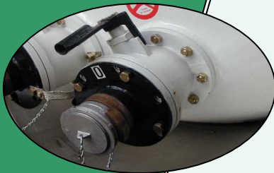
Saug- und Entleerungsschieber montiert direkt am Hinterdeckel
