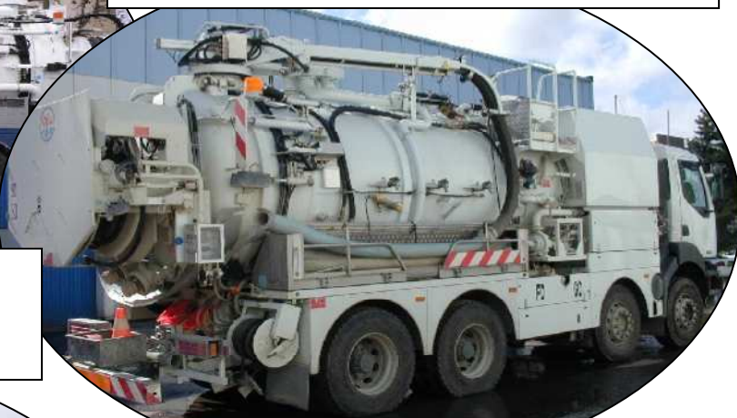
RVI KERAX 420 DCI 8X4 PHP P 3-45 P60 (348 l / 190/205 bars) PAV : VTB 820
