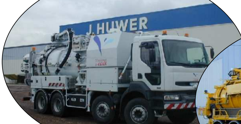
PAV : VTB 820 PHP P 3-45 P65 (348 l / 190/205 bars) RVI KERAX 370 DCI 8X4
