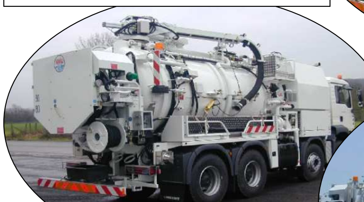
MAN TGA 35-350 8X4 PHP P 3-45 P60 (348 l / 190/205 bars) PAV : VTB 820
